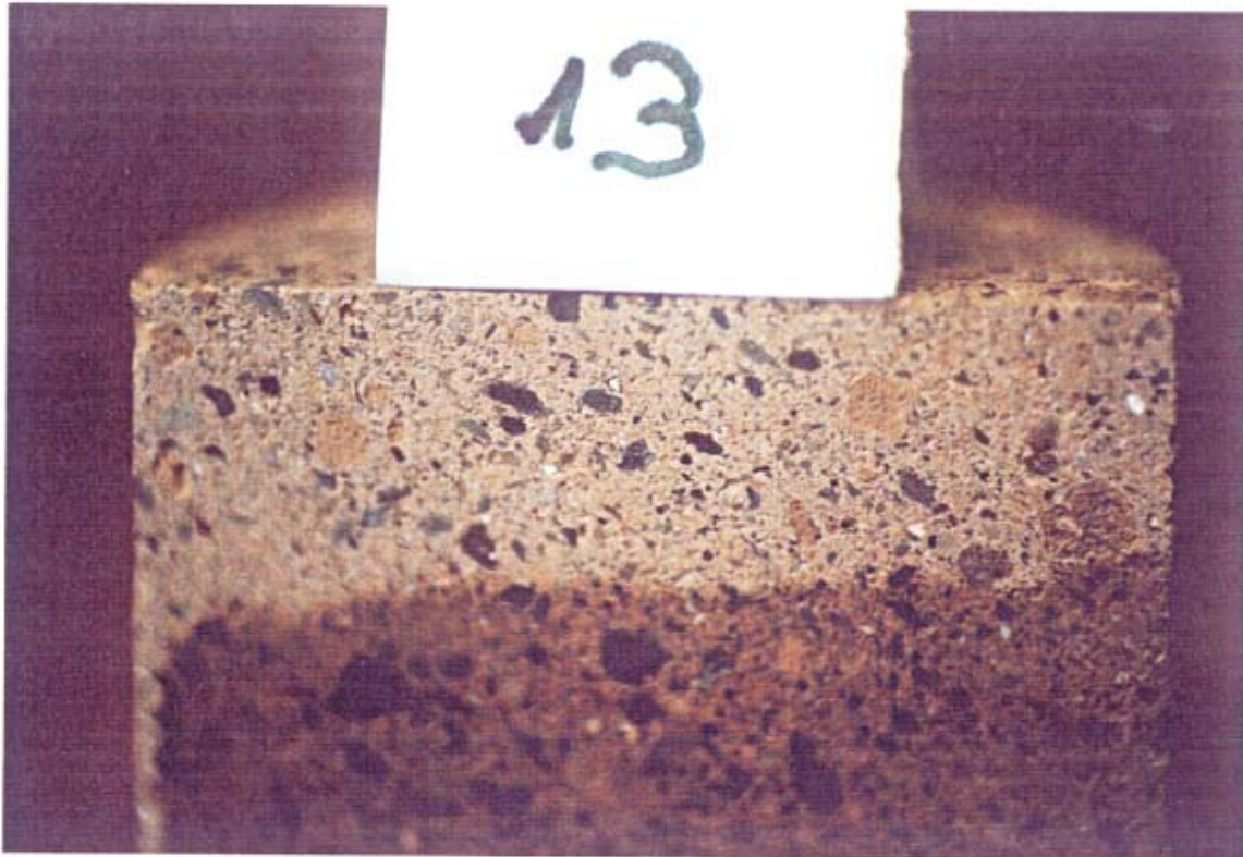
Eindringtiefen von 1,2 cm wurden bei Eifeltuff erreicht, deutlich an der hellen Färbung der imprägnierten Bohrkernhälfte nach Befeuchtung.
